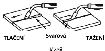
Pro většinu svařovacích prací budete tlačit hořák podél svarového spoje využívaje lepší viditelnosti svarové lázně.
