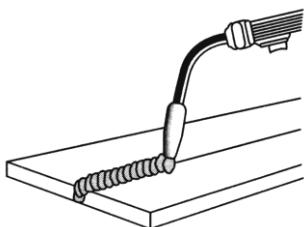
**Poloha vodorovná na svislé stěně** je prováděna velmi podobně jako poloha vodorovná s výjimkou toho, že úhel B je viz.Obr.níže, hořák a drát je držen blíž ke svařové lázní, aby se zabránilo stékání svarového kovu dolů, aniž by se tím zpomalila rychlosť posuvu hořáku ve směru svařování. A dobrým výchozím bodem pro úhel B je asi 30 stupňů dolů z kolmé stěny svarku.
