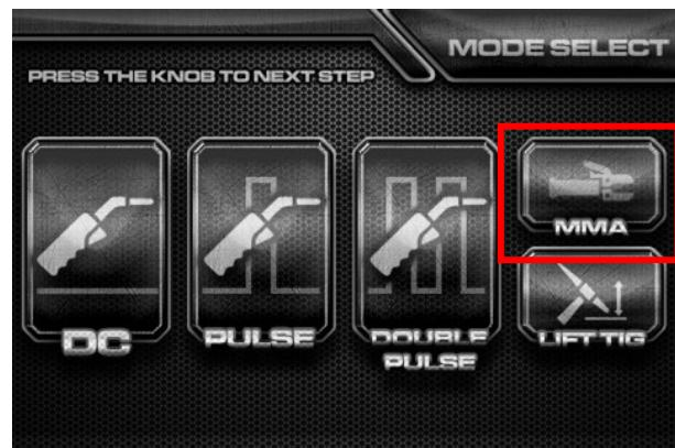
Na obrazovce LCD se zobrazí přednastavený svařovací proud (MMA). Tento lze upravit otáčením nastavení parametrů svařování ovladačem (3).
