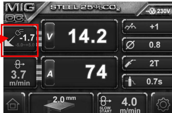
Poté pomocí levého ovladače (1) upravte svařovací napětí -5 ~ + 5V ze standardního synergického nastavení. **Tím se nezmění rychlosť podávania drátu.** Pro snadné použití se doporučuje, aby se cílová rychlosť posuvu drátu nastavila nejdříve a poté se v případě potřeby jemně vyladilo nastavení napětí. Doporučená společná nastavení naleznete ve
