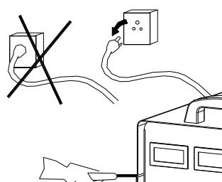
Před otevřením krytu zdroje – vždy odpojit ze sítě!
