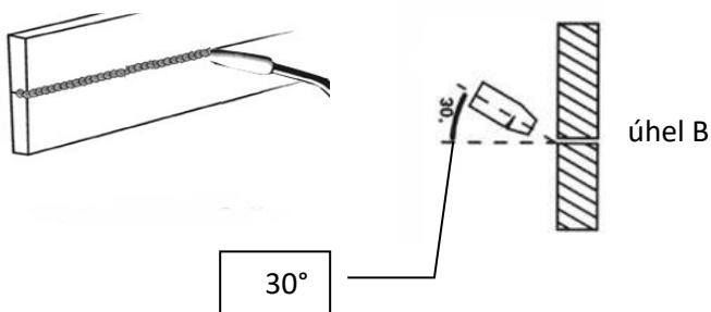
**Poloha svislá tažení hořáku z hora dolů** je pro mnoho lidí jednoduší. Může být obtížné, aby se zabránilo stékání svarového kovu.
