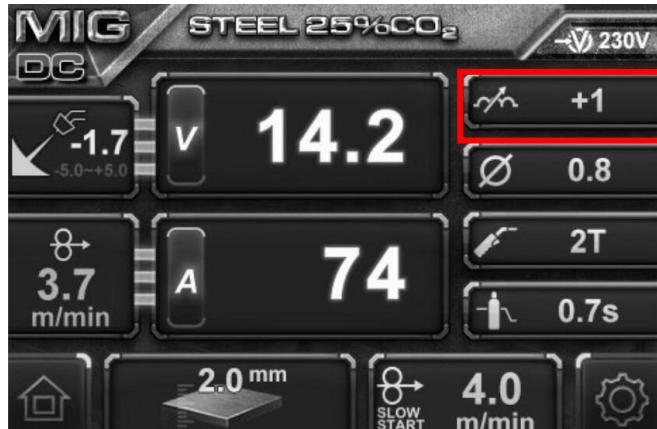
**Výchozí hodnota indukčnosti je 10, doporučuje se tuto hodnotu zachovat, pokud operátor není zkušeným svářecem.**
